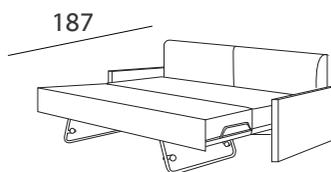
*Struttura:* acciaio ad alta resistenza, legno massello e agglomerato di legno, tutto rivestito con lastre di poliestere.
